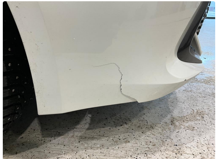
1.4 Støtfanger er sprukket på høyre side.
