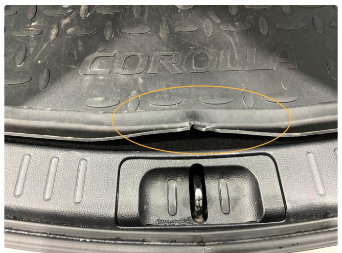
3.1 Bagasjeromsmatte har vært klemt i låsen. Litt deformert.
