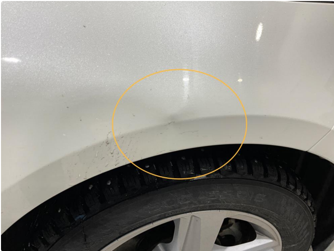
1.1 Liten bulk med lakkskade. Høyre foran.
