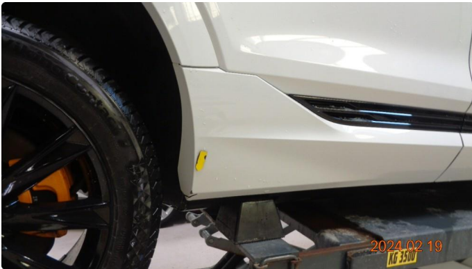
1.1 Sprekk nedre dørdeksel høyre bakdør - byttes
