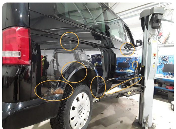
3.5 Generelt mye rust -og noen bulker
