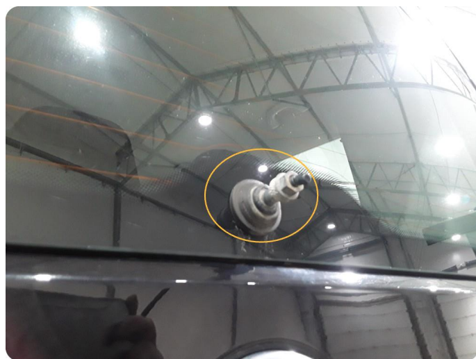
3.7 Pussearm defekt /mangler
