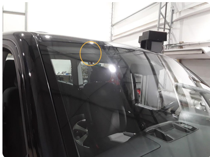
3.11 Steinsprut med sprekk
