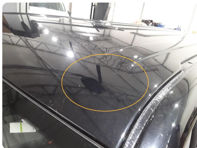
3.10 Steinsprut med rust
