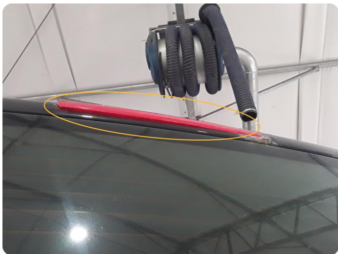
4.1 Defekt / sprukket glass
