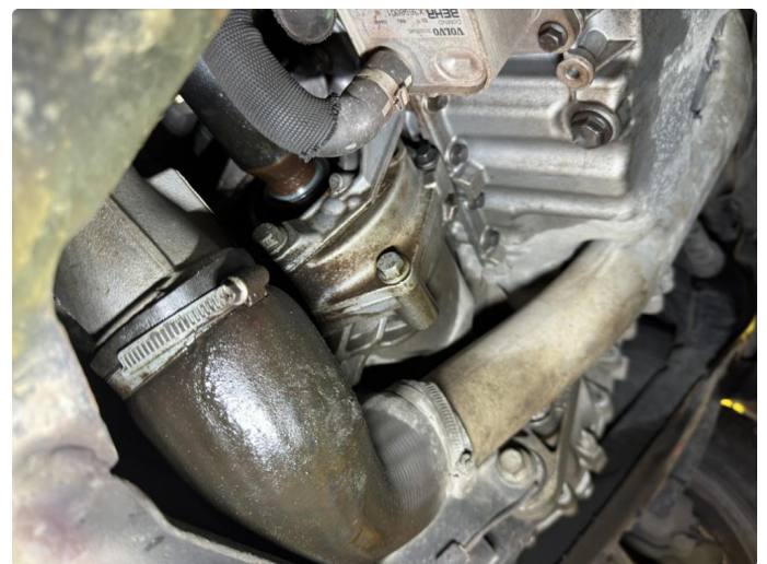
3.1 Lekkasje fra tettering på fordelingskasse, høyre inng drivaksel. Utbedres 04/24
