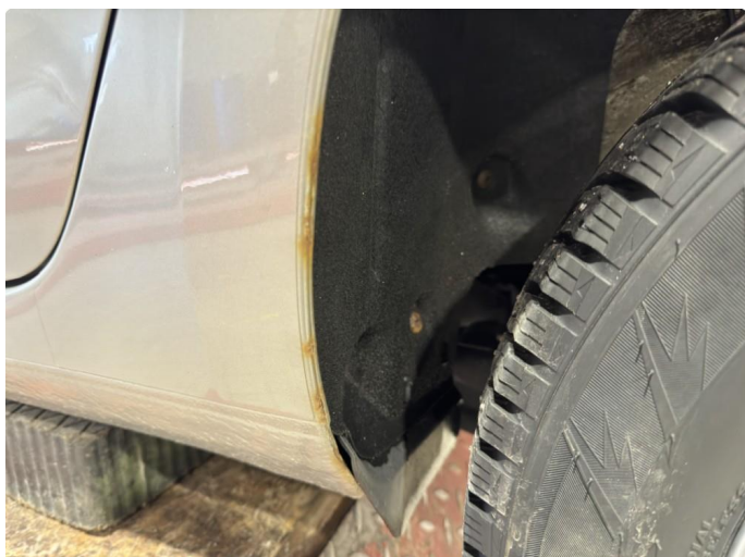
2.1 Høyre og venstre bakpanel har rust og lakken er avskallet
