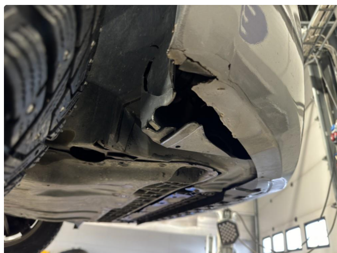
2.3 Støtfanger foran ripet og skade under på høyre side
