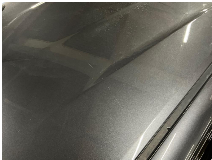
1.10 En del riper på taket.
