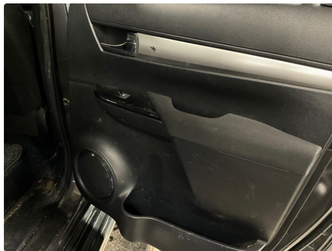
2.2 Slitasje på dørtrekk. Høyre bak og venstre foran
