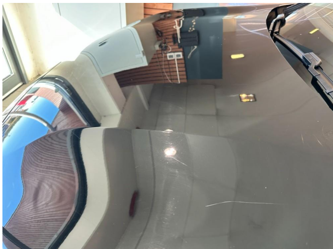
1.1 Steinsprut og ripe.
