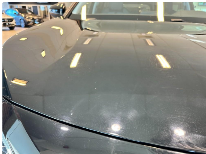
1.1 Steinsprut og ripe.
