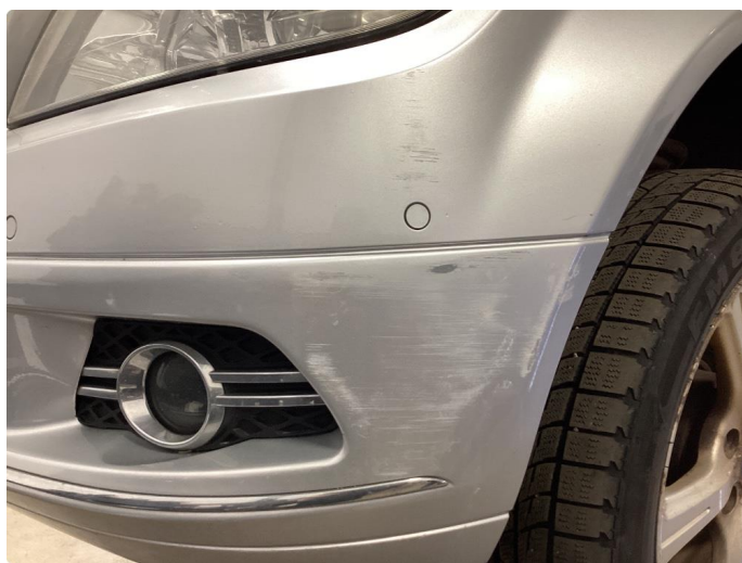
1.6 Ripe(r) ned til grunning
