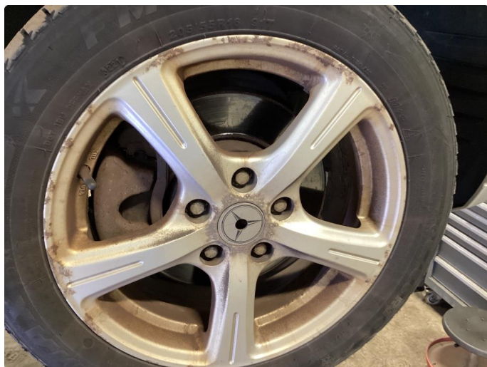
1.4 Skade på felg
