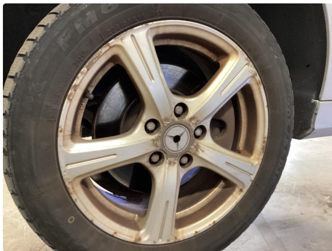
1.4 Skade på felg
