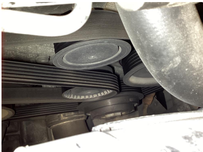
3.2 Reim detter nesten av. Må feilsøkes om reimstrammer og løpehjul er defekt + ny reim.
