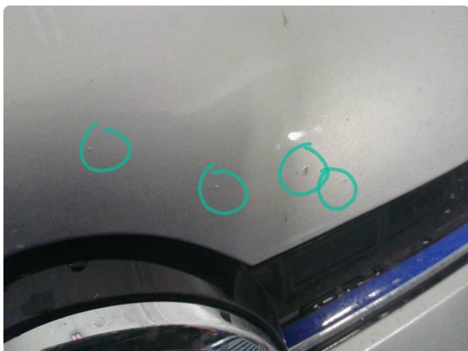
1.1 Noe steinsprut med rust
