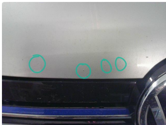
1.1 Noe steinsprut med rust
