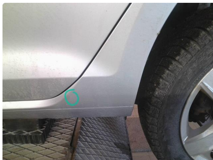
1.3 Steinsprut med rust
