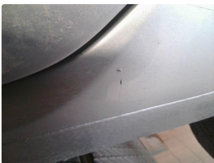
1.3 Steinsprut med rust
