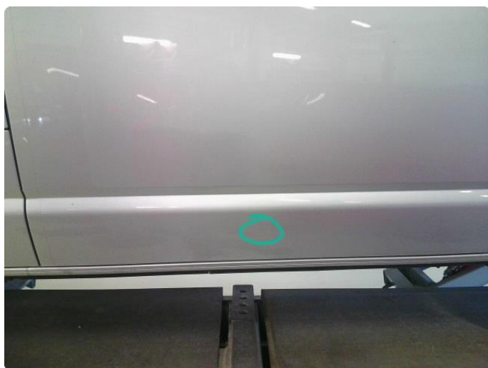
1.4 Steinsprut med rust
