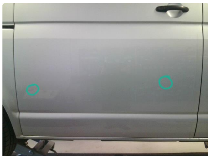
1.2 Steinsprut med rust
