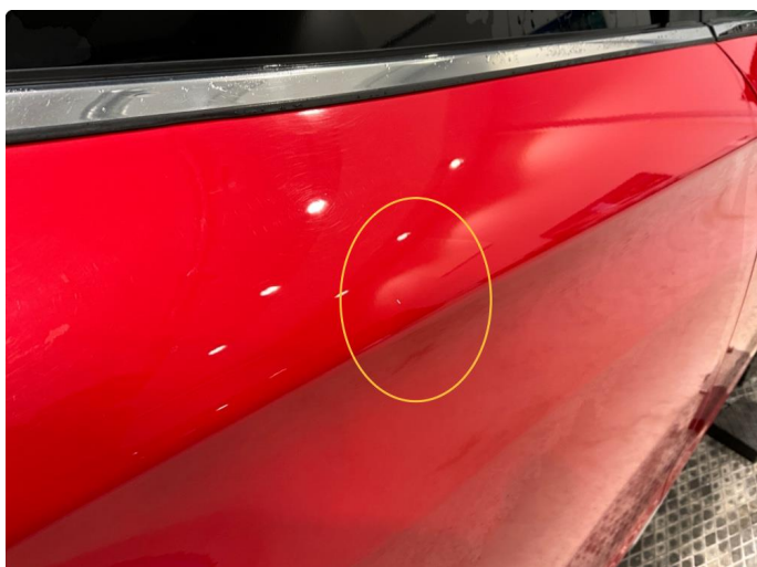
1.3 Liten bulk med lakkskade på høyre bakdør.
