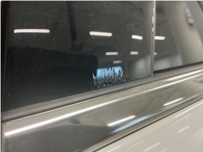
1.1 Noe krakelering i plastikk pyntedeksel utv. v. bakdør
