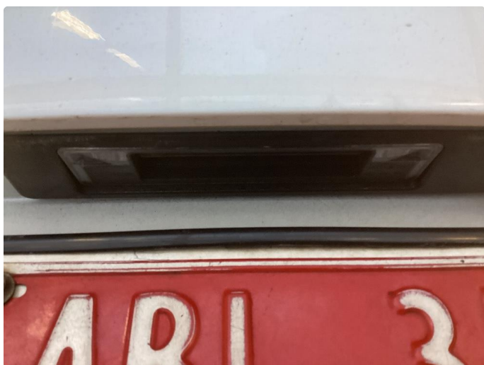
2.1 Krakelering i plast. Utført
