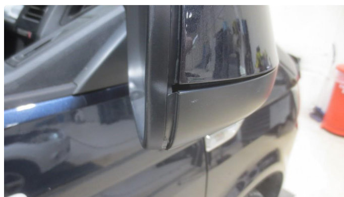
1.2 Skadet deksel til høyre speil
