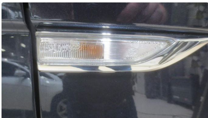
2.2 Påvist dugg i høyre blinklykt
