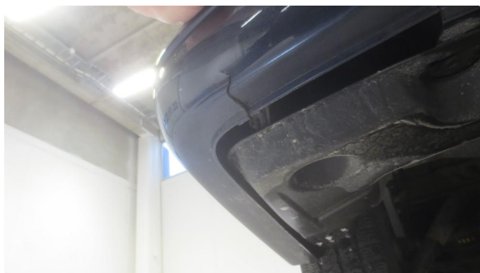
1.5 Fangerkappe bak sprukket venstre side samt bulk - repareres
