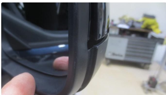
1.2 Skadet deksel til høyre speil
