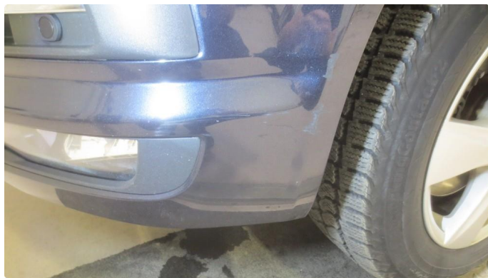
1.4 Skade høyre side foran, fangerkappe, hovedlykt, gitter og forskjerm. samt skrapeskader venstre side - utbedres
