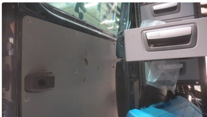
4.1 Dørtrekk høyre skyvedør skadet
