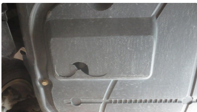
1.1 Hull i beskyttelsesplate under motor
