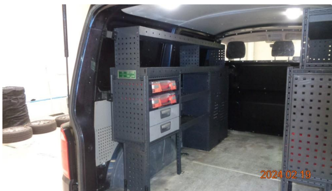
4.3 Normal slitasje varerom, en del riper og noe rust innvendig. Montert hyllesystem
