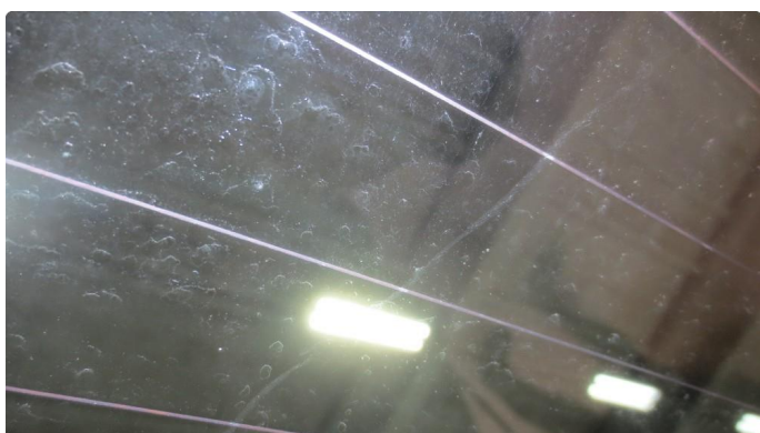
1.7 Varmetråder defekt i bakrute
