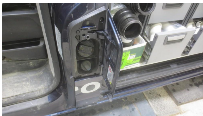
1.8 Tankpåfyllingsdeksel noe defekt - justeres
