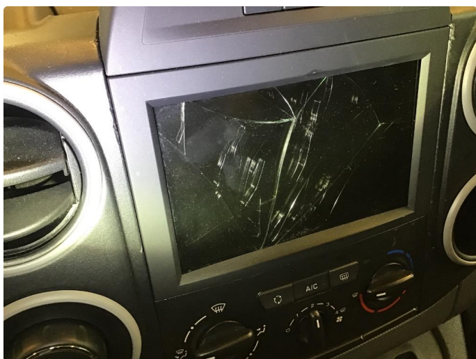
5.1 Sprekk i skjerm
