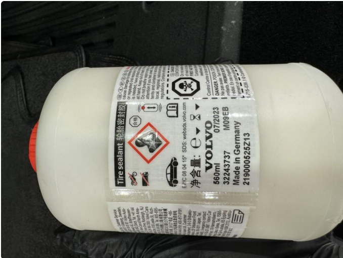
1.1 Dekk middel utløpt på dato. Byttes.
