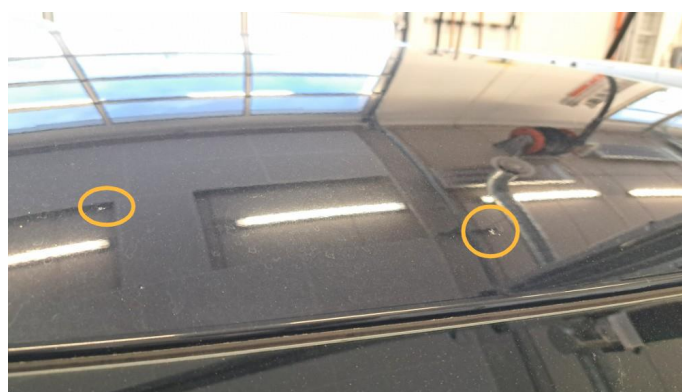
1.9 Steinsprut i framkant.
