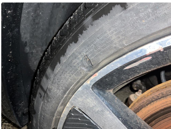
1.2 Sår i gummi sidevegg h. Dekk foran vinter. Ikke mangel på PKK
