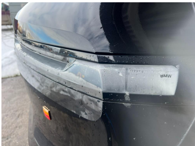
1.1 Dugg/fukt/ Byttes på garanti
