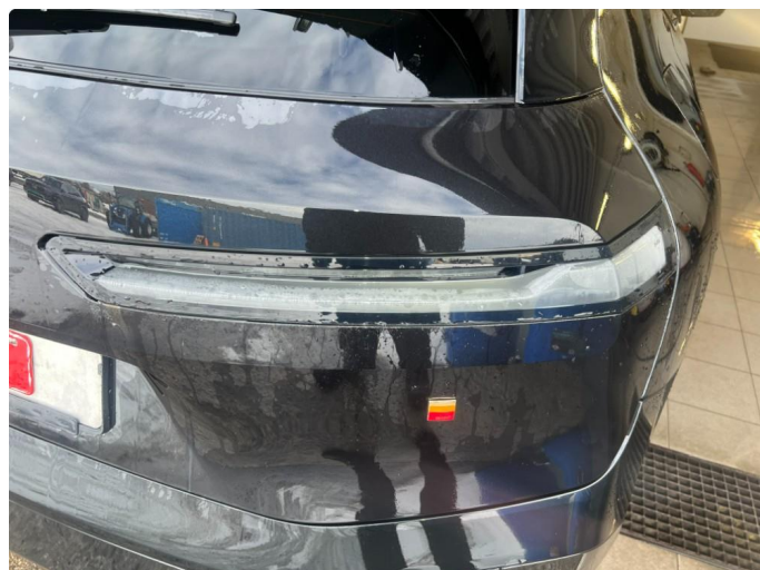
1.1 Dugg/fukt/ Byttes på garanti
