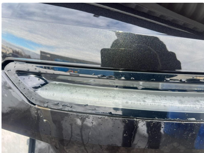
1.1 Dugg/fukt/ Byttes på garanti
