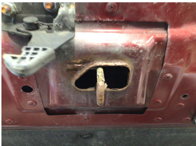
1.1 Rust i fals
