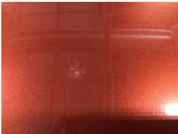
1.8 Steinsprut med rust
