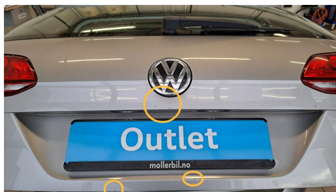
1.2 Riper og lakkskader.
