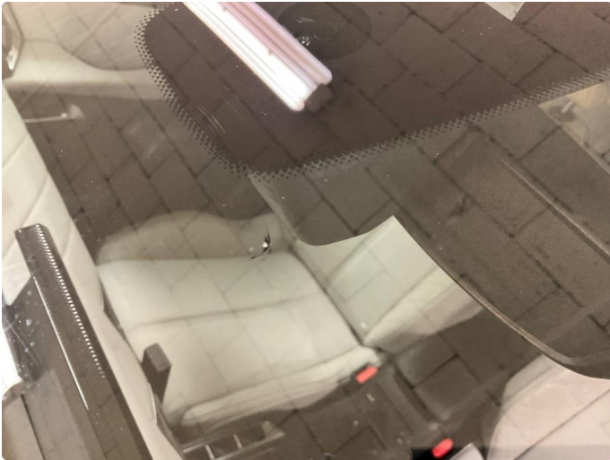
1.1 Steinsprutskade frontrute oppe ved innv. speil. Denne er reparert.
