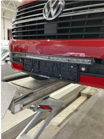
1.1 Ettermontert LED-bar foran
