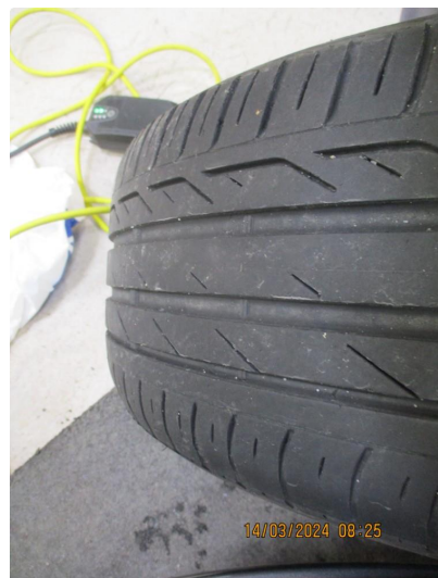
1.3 2 sommerdekk noe innsideslitt. Ok.
