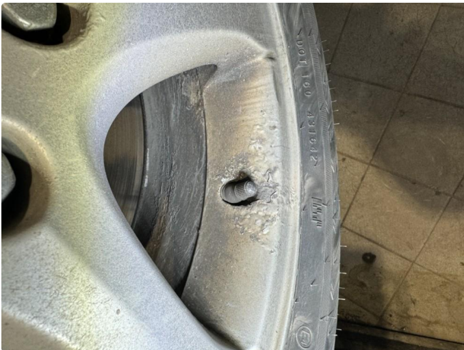
1.2 Noe maling flasser på felg, se bilde
