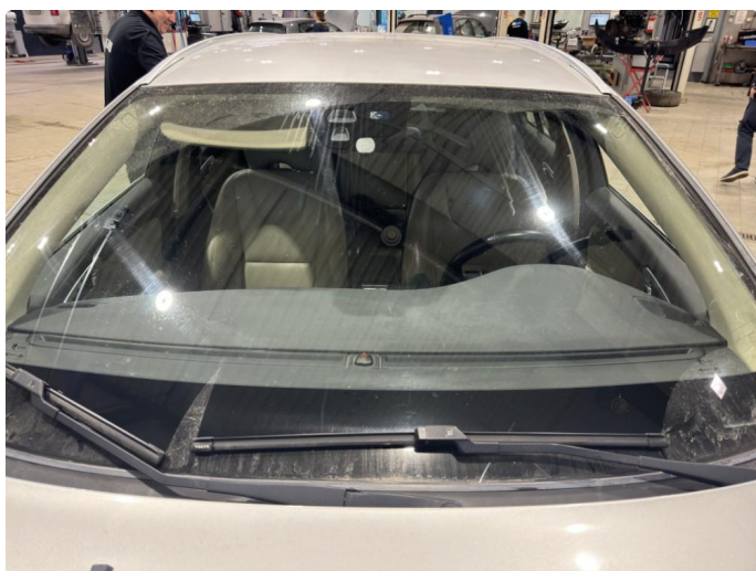
1.4 Mindre merker etter steinsprut
