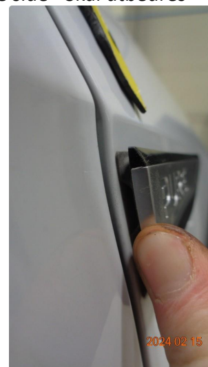
1.2 Løst emblem høyre forskjerm - Skal byttes
