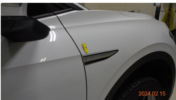
1.2 Løst emblem høyre forskjerm - Skal byttes
