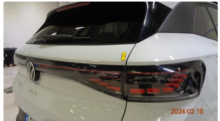
1.1 Løs baklykt i bakluke og gnisseskade lykt mot bakluke høyre side - Skal utbedres
