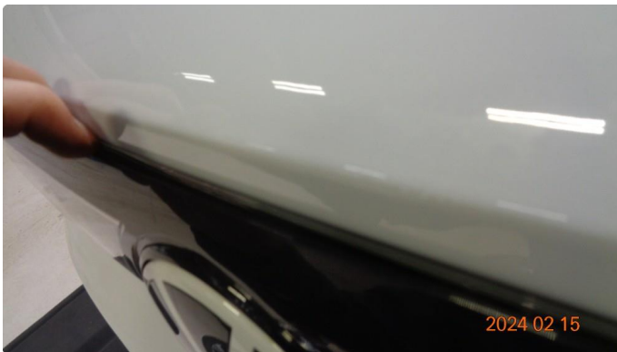
1.1 Løs baklykt i bakluke og gnisseskade lykt mot bakluke høyre side - Skal utbedres
