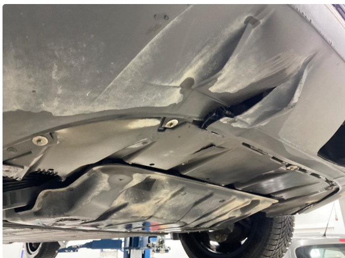
1.1 Beskyttelsesplate skadet/mangler - utbedres ved service
