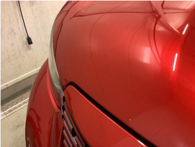
1.1 Steinsprang panser flekket
