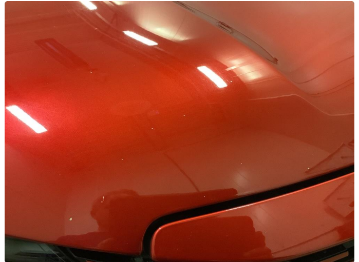
1.1 Steinsprang panser flekket
