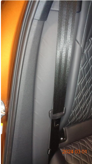
1.1 Noe deformert ryggtrekk C-stolpe til høyre baksete
