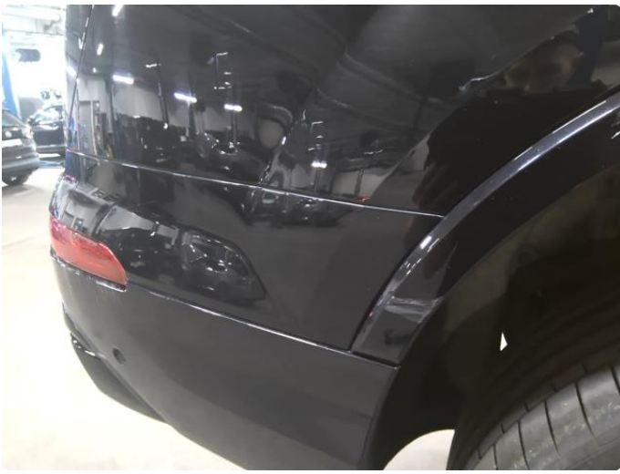
1.6 Skjermtutbygger skadet. Normalt ihht alder og km-stand
