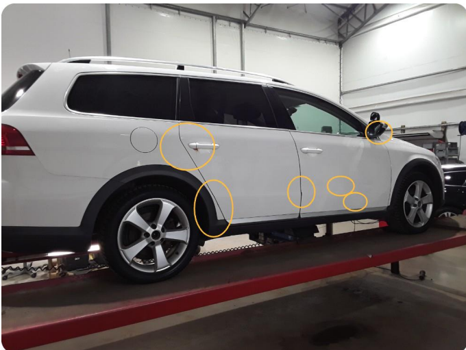
2.2 Generelt mye riper Rust og bulker
