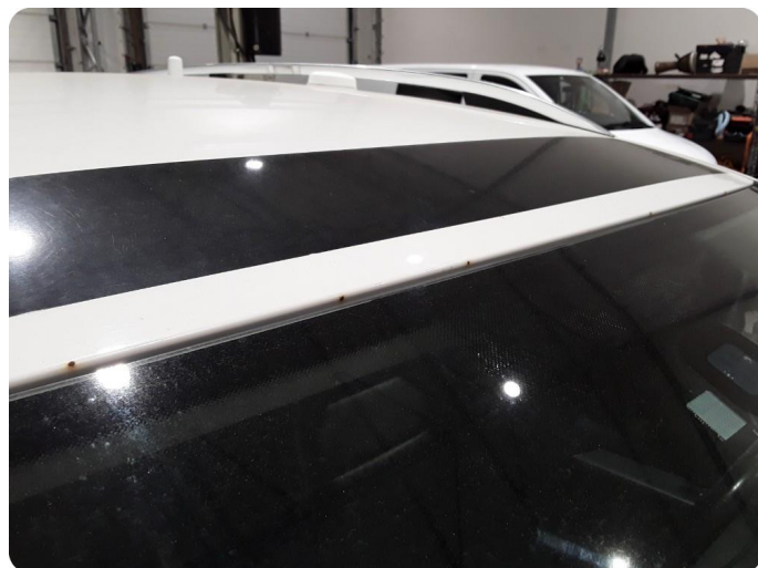
2.8 Steinsprut med rust Og hull
