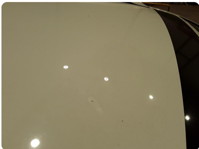
2.8 Steinsprut med rust Og hull
