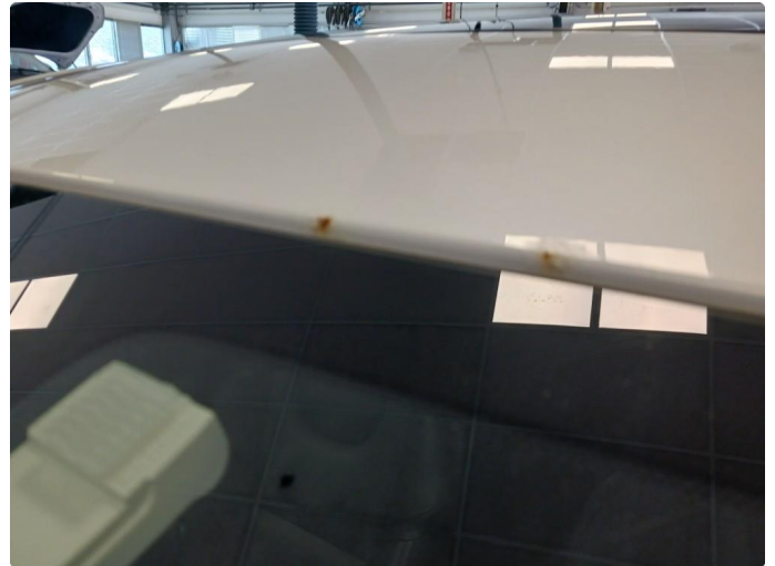
1.2 Tak lakkert pga steinsprut med rustblemmer
