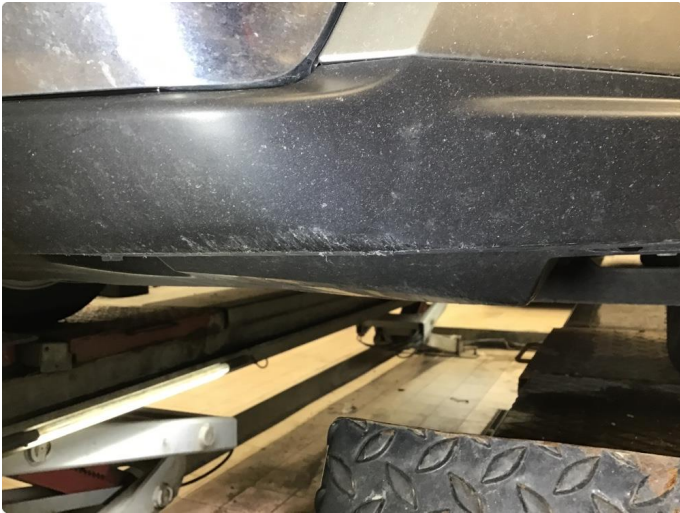
1.1 Små skrubbskader underkant av støtfanger - Bruksmerke
