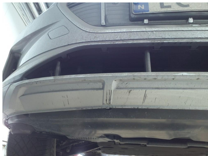
1.1 Ripe(r) ned til grunning
