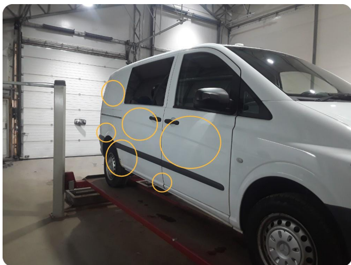
3.1 Generelt mye bruksslitasje (bulker, noen riper og rust)
