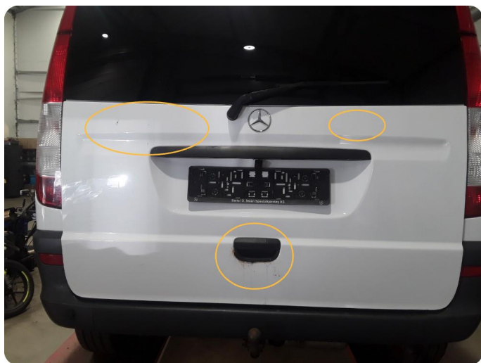
3.2 Rust/korrosjon Og riper
