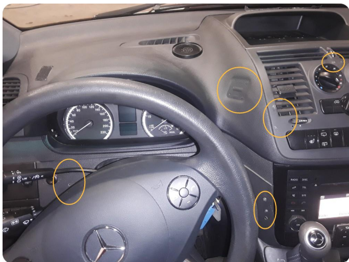
8.1 Skadet/merker etter utstyr
