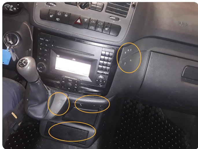
8.1 Skadet/merker etter utstyr
