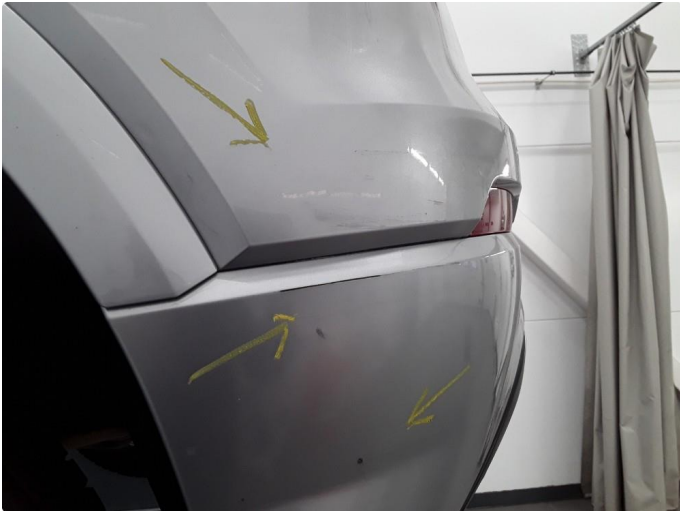
1.2 Ripe på støtfanger bak venstre side. Flekkes med lakkstift
