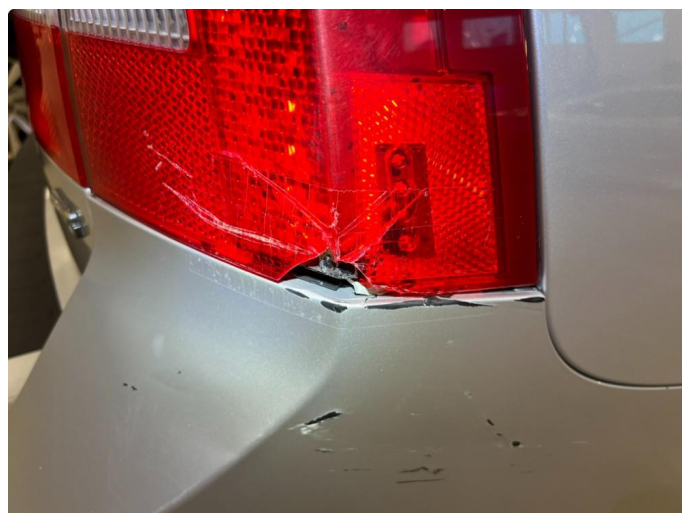
1.3 Skade- flekker i lakk
