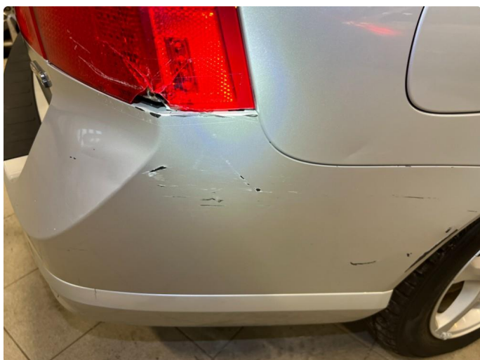
1.3 Skade- flekker i lakk
