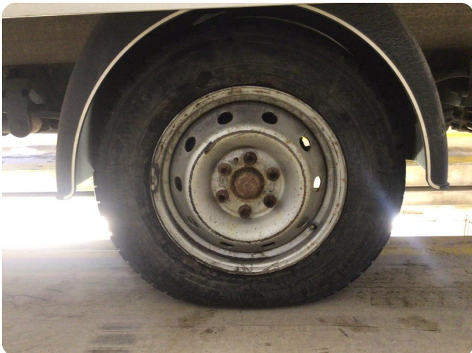
1.3 Holder ikke luft/lite luft Luft blir borte! Defekt ventil
