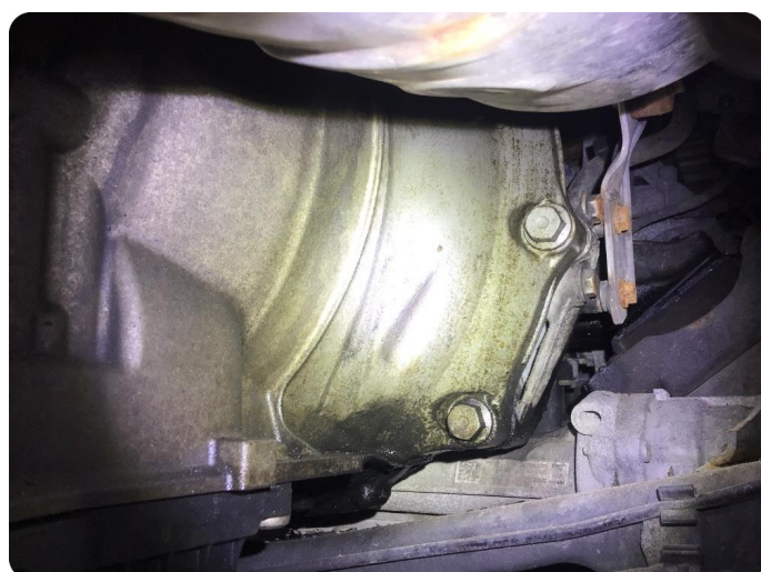
3.1 Oljelekkasje mellom motor/gear Feilsøk bør foretas! Forbehold om pris!
