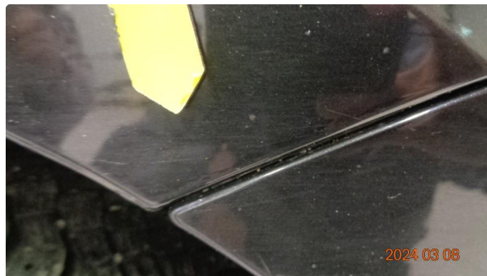
1.5 Skade støtfanger bak og rust venstre baksjerm - Skal utbedres
