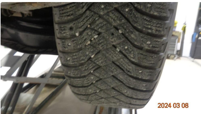
1.2 2 piggdekk mangler pigger - Skal byttes
