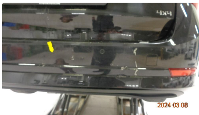
1.5 Skade støtfanger bak og rust venstre bakskjerm - Skal utbedres
