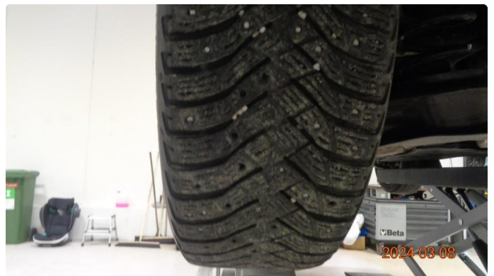
1.2 2 piggdekk mangler pigger - Skal byttes
