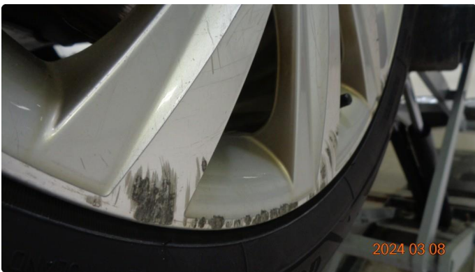
1.1 1 stk kantkjørt vinterfelg - Skal byttes
