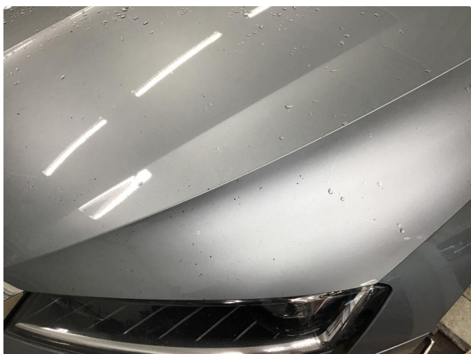
1.1 Steinsprut /Brukslitasje panser
