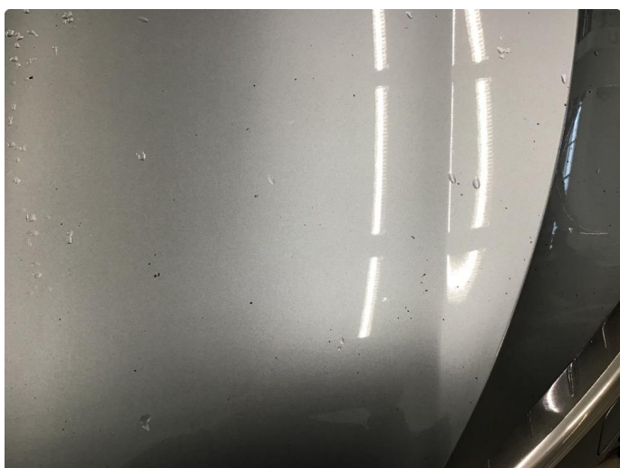
1.1 Steinsprut /Brukslitasje panser
