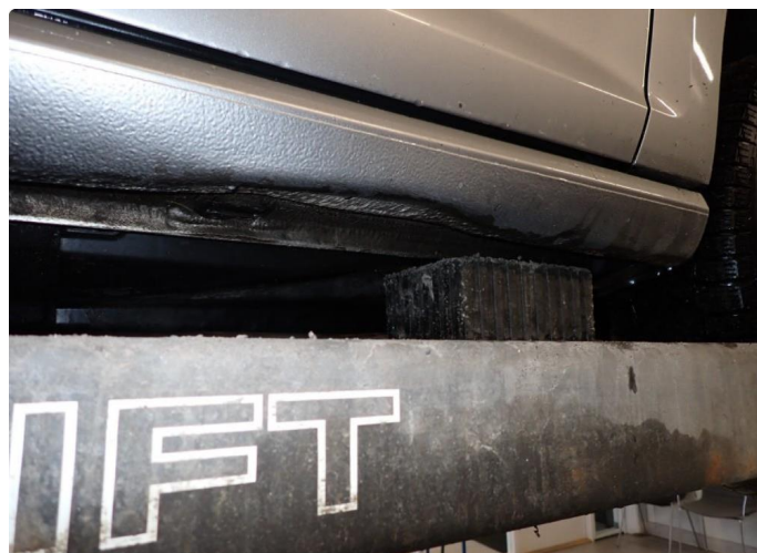
1.5 Bulk kanal venstre side
