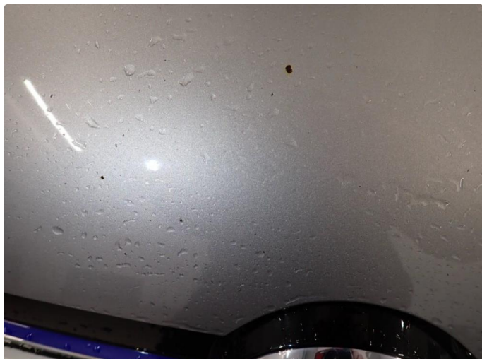
1.1 Steinsprang med noe korrosjon på panser.
