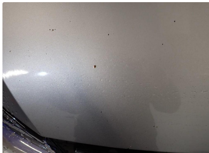
1.1 Steinsprang med noe korrosjon på panser.
