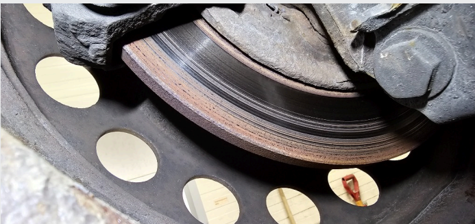
9.7 Rust på innside skiver foran
