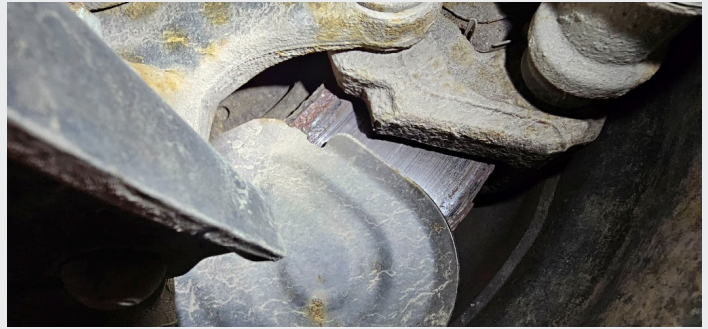
9.7 Rust på innside skiver foran
