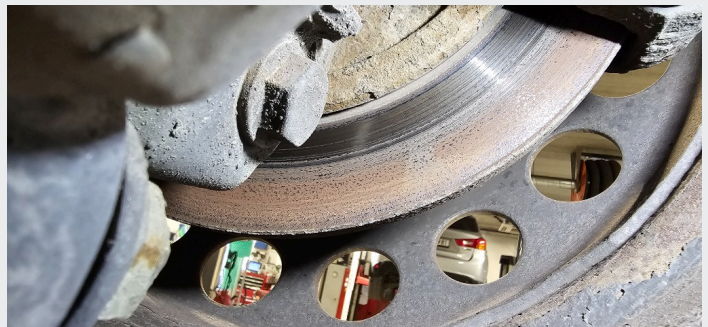
9.7 Rust på innside skiver foran
