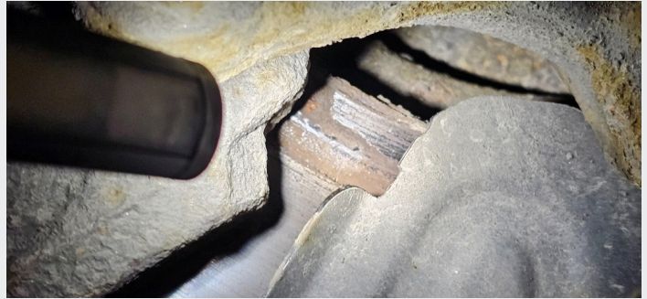
9.7 Rust på innside skiver foran
