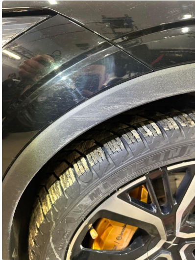
1.1 Merker på plast på hjulbuelist venstre side forran.
