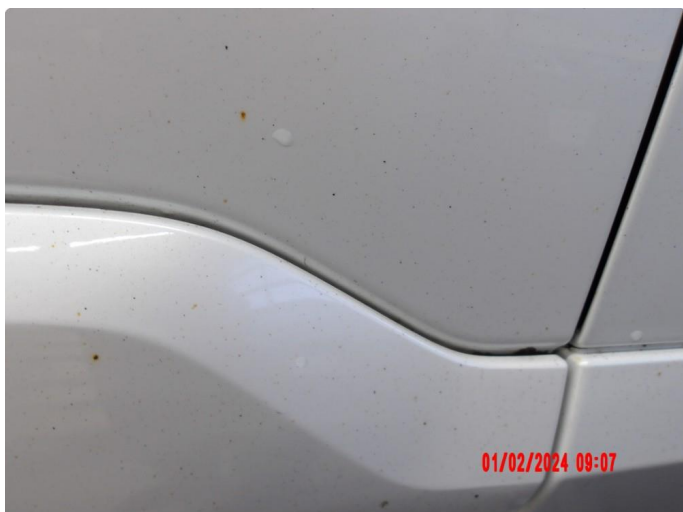
1.1 Forurensing lakk ytre påvirkning
