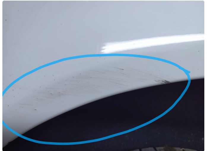
1.1 Ripe(r) ned til grunning
