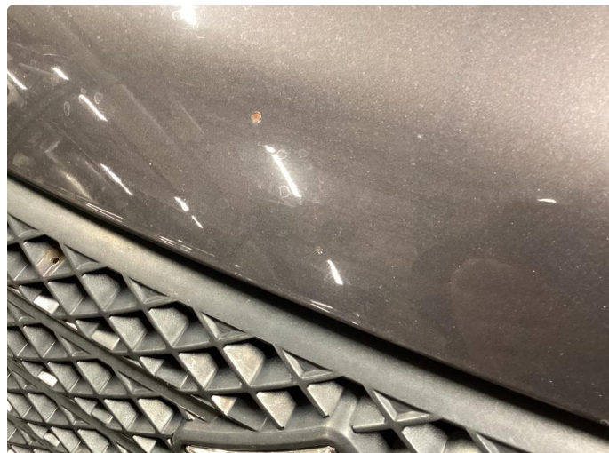
2.2 Noe steinsprut med rust
