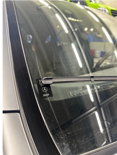
1.2 Merke etter defekt vindusvisker. (skiftet vindusvisker)
