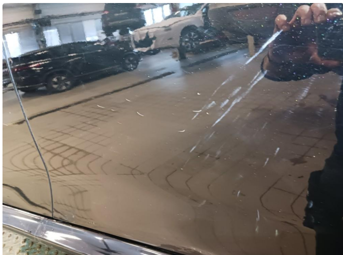
1.2 Høyre fordør lakkert opp pga riper
