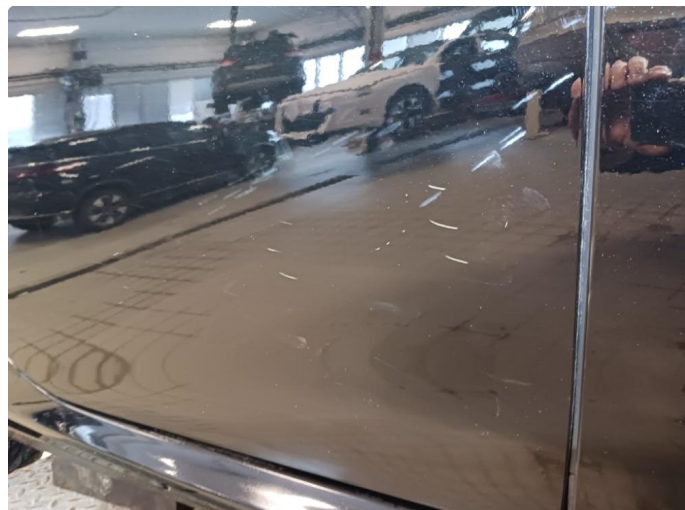
1.3 Høyre bakdør lakkert opp pga riper
