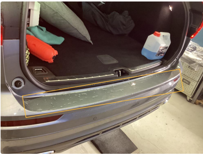
2.5 Bulk med lakkskade. Dino skla bytte på skade nr.
