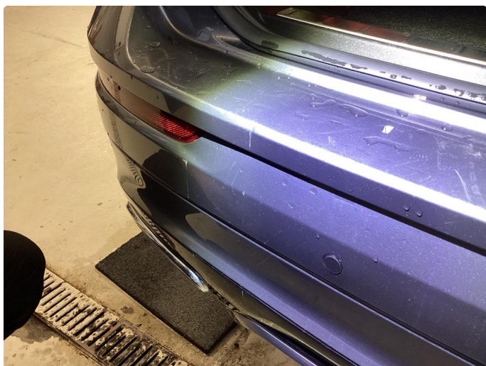
2.5 Bulk med lakkskade. Dino skla bytte på skade nr.
