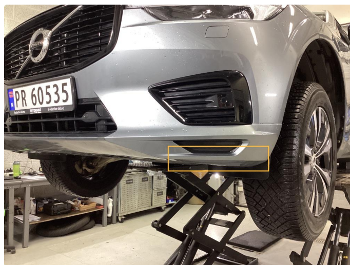
2.4 Ripe(r) ned til grunning. Dino skla bytte på skade nr.
