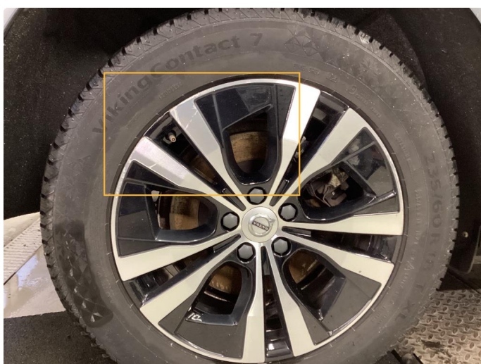
2.2 Kantkjørt felg. Dino skla bytte på skade nr.
