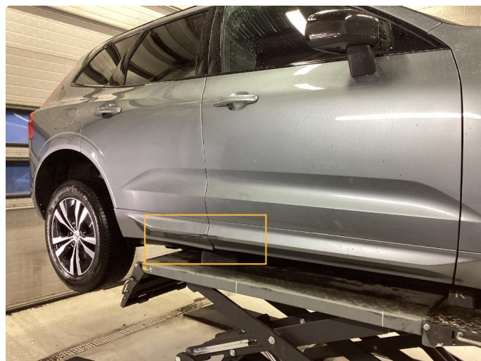
2.1 Løse/skadede lister. Dino skla bytte på skade nr.
