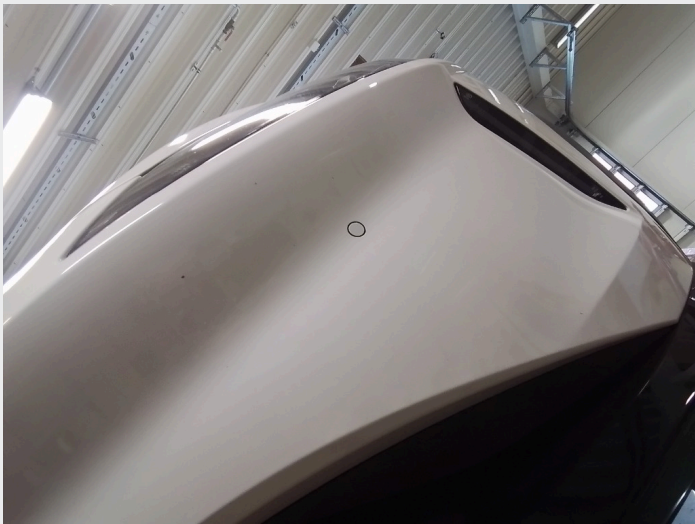
2.8 Små steinsprut på nedkant støtfanger
