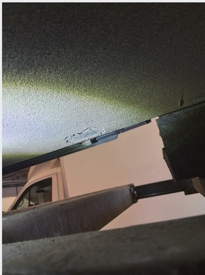
5.2 Små riper i høyspentbatteri, men ikke tegn til bulk
